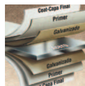
Sistema de prevención contra la corrosión
